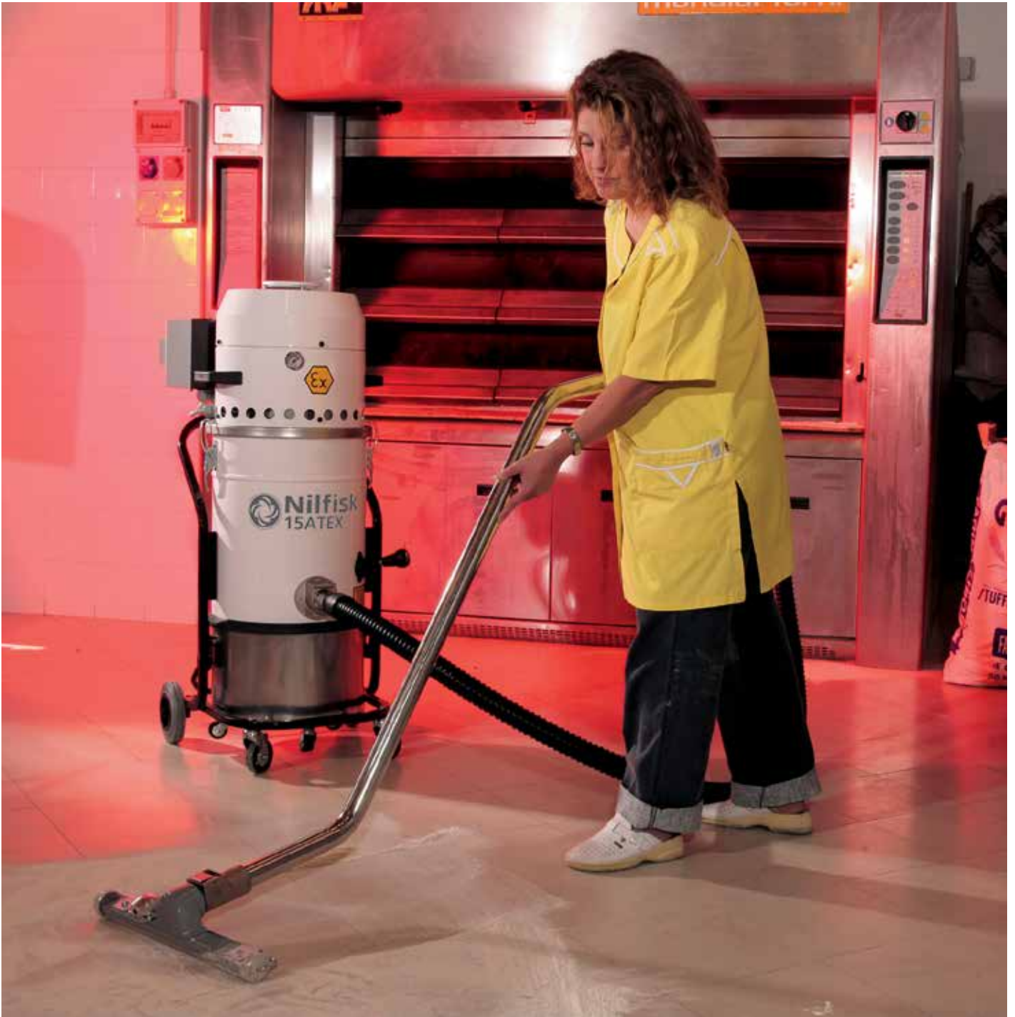
Boulangerie, aspiration de la farine sur le sol
