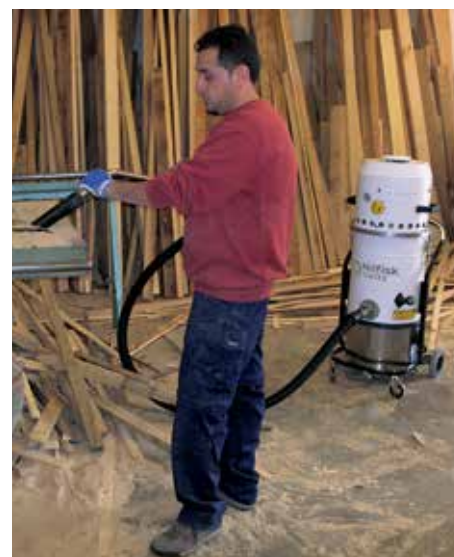
Menuiserie, élimination de la poussière sur une scie à courroie
